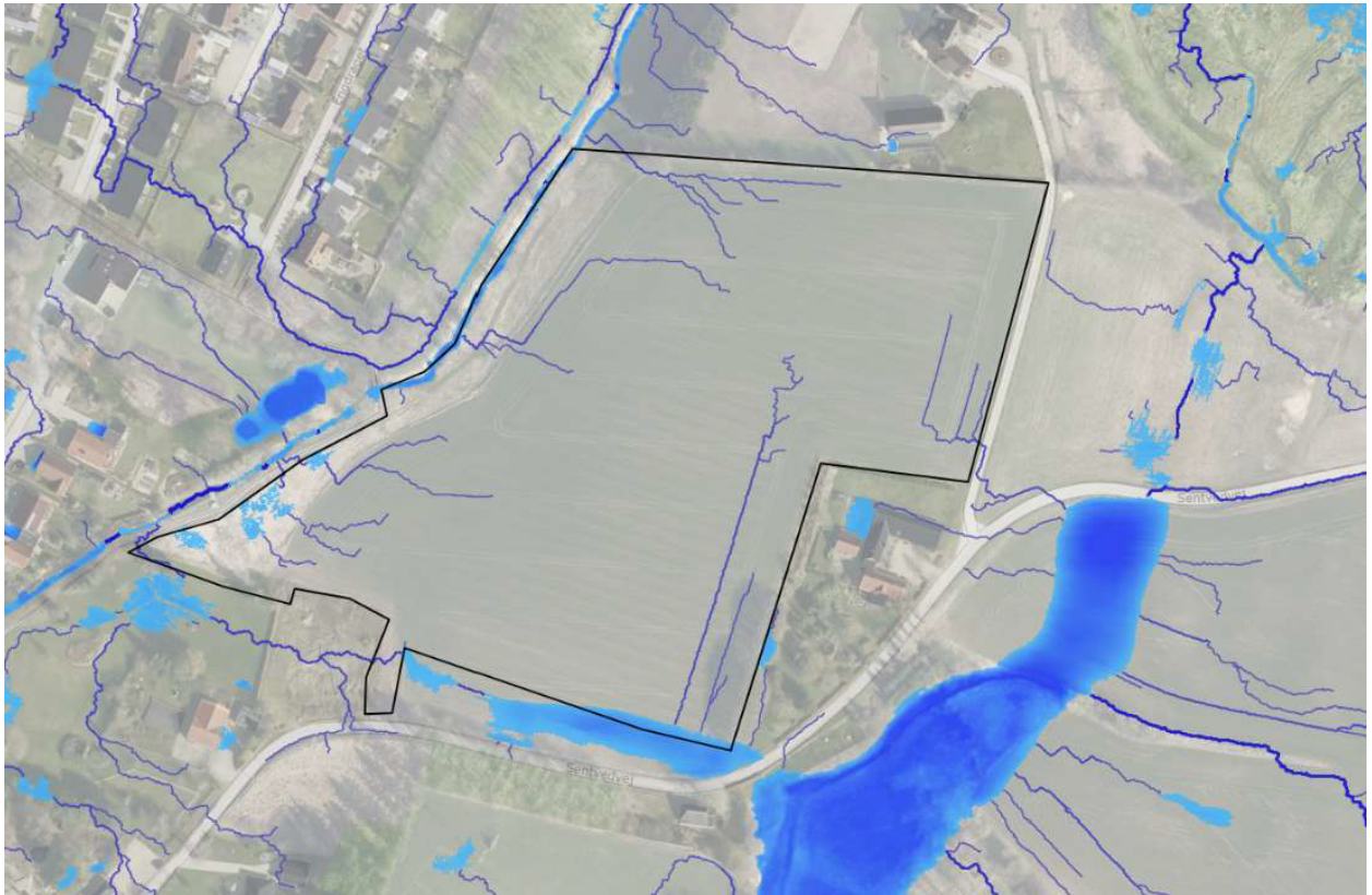
Figur 9 - Strømningsveje og oversvømmelser for 100 mm regn på terræn (regnet som en uigennemtrængelig flade) fra SCALGO Live.
