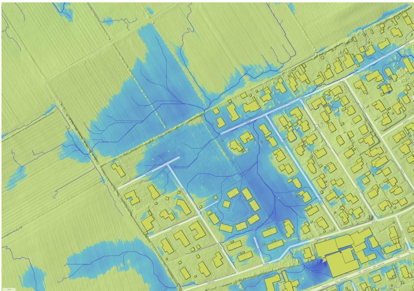
Figur 1 viser oversvømmelser ved skybrud baseret på en 100 års hændelse fratrasket kapaciteten på regnvandskloakken (5 års hændelse) fremskrevet til om 100 år. Oversvømmelserne er vist sammen med de generelle strømningsveje i området.
